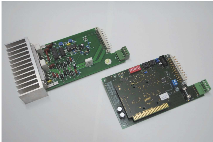
Bild 2: smOOver.opt mit aufgestecktem smOOver.drv (vorne rechts) im Vergleich zur original „CNC-Steuerkarte“ (hinten links).
