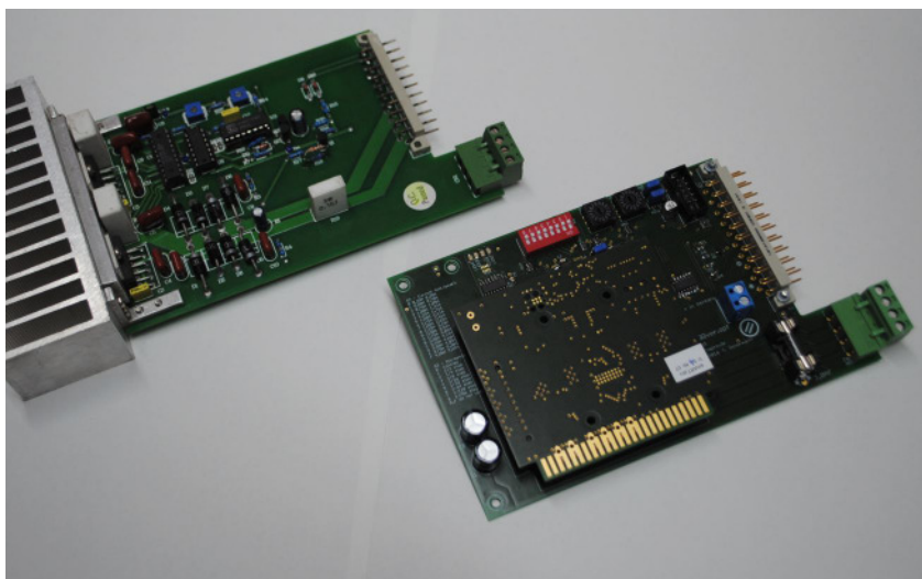
Links: Original CNC Steuerkarte, rechts: smOOver.op mit smOOver.drv
