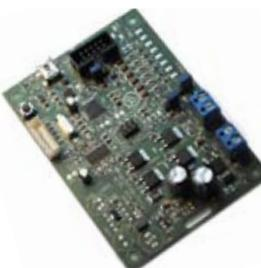
Kundenspezifisch entwickelter DC-Motor Controller für Papierabwickler mit Tänzersteuerung. Parametrierung über USB-Schnittstelle.
