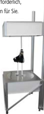
2-Achsiges Drehtisch für die automatisierte 3D-Produktfotografie. Verwendete Steuerungskomponenten: Endstufem LAM DS10, Controller NC-Pilot USB.
